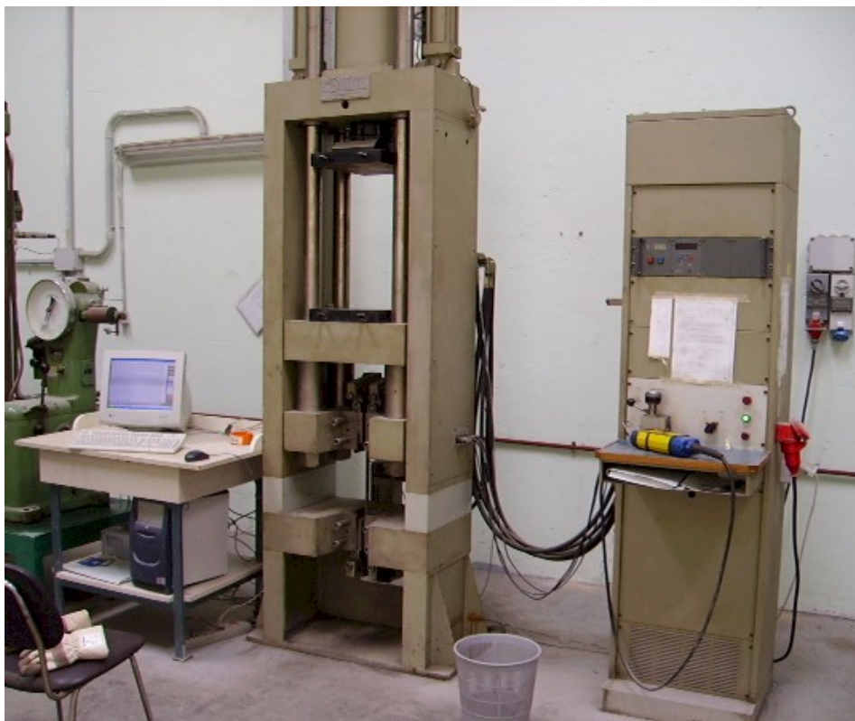
CONTROLS C 901 1000 KN con acquirente LONOS TEST
