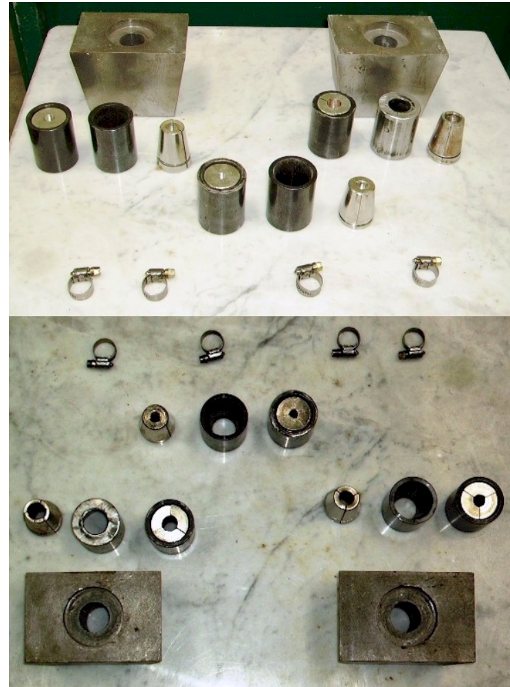
Cunei porta morsetto e morsetteria
