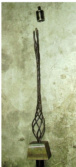
Il campione rotto dell'estensimetro
