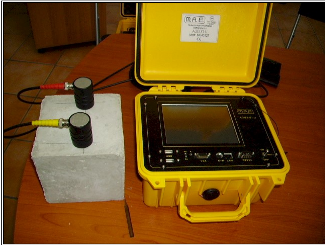
Centralina di acquisizione dati, sonda di trasmissione, sonda di ricezione.
