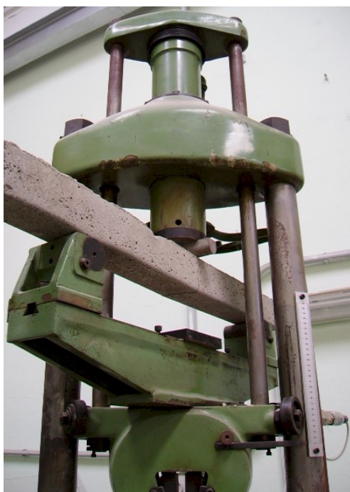
L'universale impostata per le prove di flessione e la cassaforma in acciaio per provini prismatici
