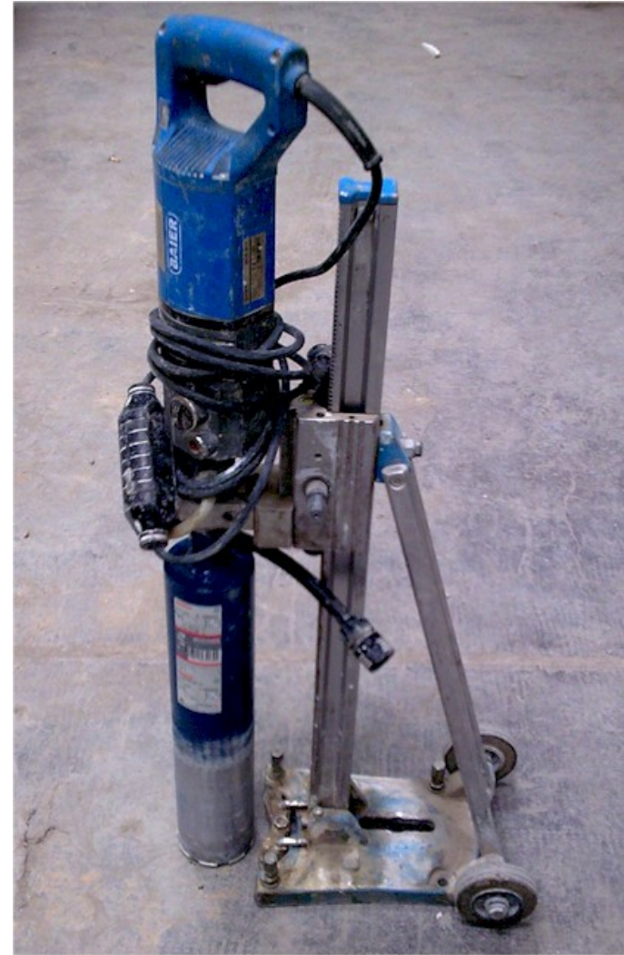
Carotatrice BAIER, Carotiere BOSCH \phi 102 L450
