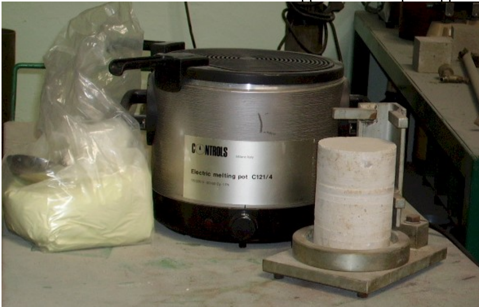
Carote di calcestruzzo H = 1.5 D e H = 2 D e apparecchiatura per cappatura
