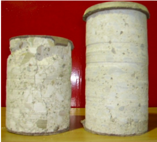
Carote di calcestruzzo H = 1.5 D e H = 2 D e apparecchiatura per cappatura
